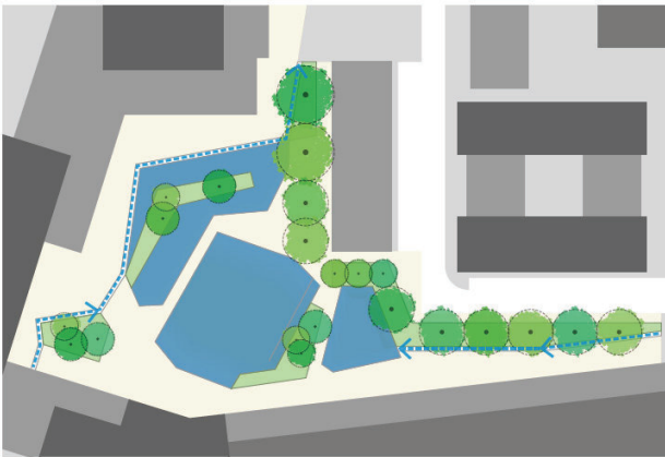
Figura 6-19: Schematizzazione dell'entità dell'allagamento a fronte dei diversi eventi pluviometrici nella piazza allagabile di Benthemplein a Rotterdam (Progetto e foto di Die Urbanisten tratto da SOS4Life "Liberare il suolo - Linee guida per migliorare la resilienza ai cambiamenti climatici negli interventi di rigenerazione urbana", Regione Emilia Romagna)
