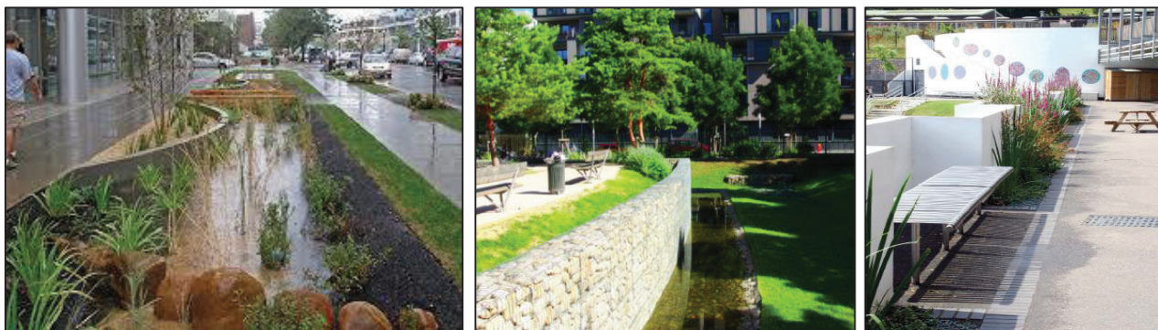
Figura 6-9: Esempi di trincee filtranti
