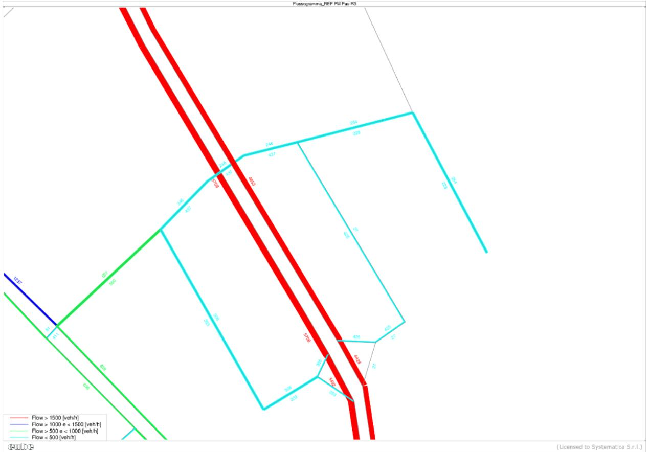
Figura 1. Flussogramma veicolare. Uscita CAMM. Ora di punta PM (17:30-18:30). Scenario di riferimento.
