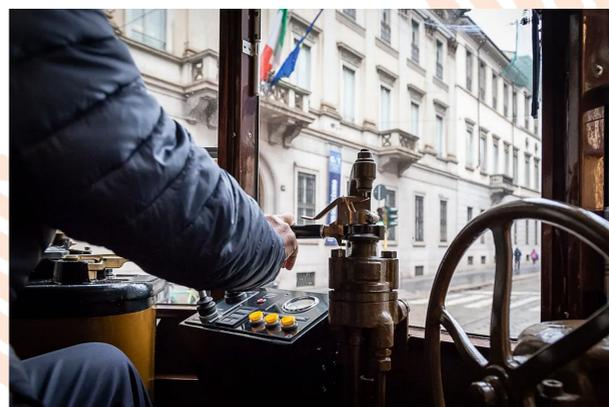
L'equipaggiamento elettrico di comando è formato da quattro motori, che permettono una velocità massima di 35 km/h, collegati a due a due in parallelo e comandati attraverso un combinatore, la famosa "manetta" K35, che ha avuto un ruolo chiave durante il grande sciopero del marzo 1944.
